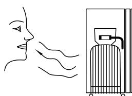
6. При підозрінні витоку перекрити доплив газу з балону. НЕ відключати редуктор. Згасити усілякі джерела відкритого вогню. Перевірити всі підключення. Повільно відкривати доплив газу, перевірючи щільність з'єднувань водою з мілом або рідким дегтергентом - на місці витоку утворяться пузырі повітря. Після визначення витоку закрити доплив газу і поінформувати про цей факт поставника газу. Не включати повторно пристрій, поки він не буде перевірений фахівцем з пункту сервісного обслуговування.
