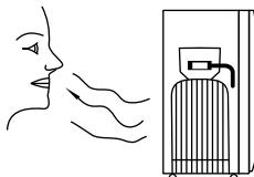
6. Если есть подозрение на утечку, перекройте подачу газа на газовом баллоне. НЕ отсоединяйте регулятор. Погасите все источники открытого пламени. Проверьте все соединения. Медленно подайте газ и нанесите на места соединений мыльную воду или жидкое моющее средство - при утечке газа появятся пузыри. Если обнаружилась утечка, перекройте газ и обратитесь к поставщику газа. НЕ пользуйтесь обогревателем вновь до тех пор, пока его не проверит Ваш дилер.
