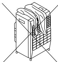
2. TILOS letakarni a hőszárítót bármilyen tárggyal vagy anyaggal. Ez a tűzveszélyen kívül a berendezés megfelelő működésére is befolyással lehet.
