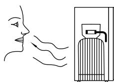
6. Gyanús folyadékszivárgás esetén, zárja el a gázpalackot. Oltson el minden nyílt láng forrást. Ellenőrizze az összes csatlakozást. A gázszelépet lassan megnyitva ellenőrizze a csatlakozás hermetikusságát szappanos vizivel, vagy folyékony mosószerrel a szívárgás helyén levegőbuborékok képződnek. A szívárgás beazonosítása után, zárja el a gázt és értesítse a gázsolgáltatót. A berendezést ne indítsa újra addig, míg azt szerelő nem ellenőrizte.
