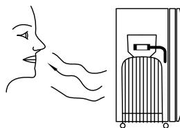
6. U slučaju da posumnjate ispuštanje plina zatvorite ventil na plinskoj boci. NEMOJTE odspajati regulator tlaka. Ugasite sve otvorene izvore vatre. Provjerite sve priključke. Pažljivo odvrnite plin i prijedite sve povezne djelove sapunicom ili drugim tekućim deterzentom - na mjestu gdje curi stvorit će se mjehurići. Ako ste ustanovili curenje obratite se svom dobavljaču. Nemojte upotrebljavati grijalicu prije nego je pregleda stručnjak.
