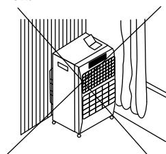
5. TILOS a hőszárítót fal mellett vagy függönyök, stb. közelében elhelyezni. A fűtőpanel mindenkorában a helyiségek belseje felé nézzen. Legyen különös figyelemmel a hőszárító elhelyezésekor arra, hogy az ne álljon olyan felszínén, melyen könnyen elgurulhat, pl. ahol kisgyermek vagy kutya, stb. könnyen elmozdíthatja.
