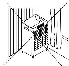
5. НЕ располагайте обогреватель вдоль стен или рядом с занавесями и т.п. Обогреватель ВСЕГДА должен быть обращен к центру комнаты. Следует принять особые меры предосторожности, если обогреватель стоит на поверхности, на которой он может повернуться на колесиках от толчка ребенка или собаки и проч.
