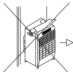
5. Ohrievač sa NESMIE postaviť pri stene a ani v blízkosti závesov, ap. Ohrevacie panely majú byť vždy nasmerované do stredu miestnosti. Zvláštnu opatrnosť je potrebné zachovať, ak je ohrievač postavený na povrchoch, na ktorých sa môže jednoducho presunúť na kolieskach, napr. strečený dieťaťom alebo psom, ap.
