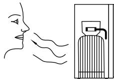
6. При подозрения за теч, прекъснете притока на газ от бутилката. Да НЕ се откача редуцир вентила. Изгасете всяки източници на отворен огън. Проверете всички свръзки. Бавно отваряйте притока на газ, проверявайки уплътнението с помощта на вода на вода със сапун или течен дезергент - при теч ще се появят въздушни меухрчета. При наличие на теч, прекъснете притока на газ и информирайте доставчика. Не включвате повторно уреда докато не бъде напълно поправен и проверен от специалист.
