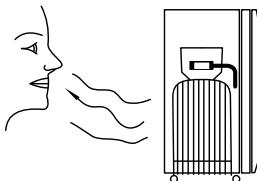
6. Če sumite, da uhaja plin, zaprite njegov dotok iz jeklenke. NE odklapljajte regulatorja. Ugasnite vse vire odprtega ognja. Preverite vse povezave. Počasi odpirajte dotok plina in medtem preverite tesnost priključkov s pomočjo vode z milom ali tekočim detergentom – na mestu uhajanja se bodo pojavili mehurčki zraka. Potem, ko ugotovite mesto uhajanja, zaprite dotok plina in obvestite dobavitelja plina. Naprave ponovno ne zaganajte, preden je ne preveri serviser.
